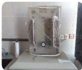
دستگاه اندازه گیری نسبت گاز به نفت
