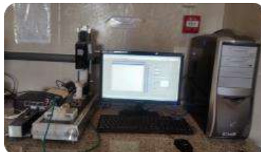
دستگاه اندازه گیری زاویه ی تماس و کشتش سطحی
