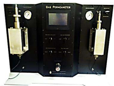
دستگاه اندازه گیری تراوایی در حالت پایا
