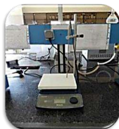
دستگاه هیتر مگنت با پروپ تنظیم دما
