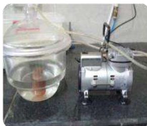
دستگاه اندازه گیری تخلخل با روش اشباع در خلا
