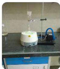
دستگاه اندازه گیری اشباع مغزه
